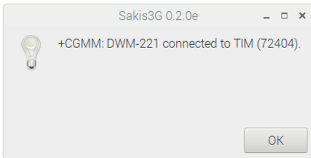
Figura 6. Conexão bem sucedida do raspberry com a rede 4G da operadora TIM através da aplicação sakis3g.
