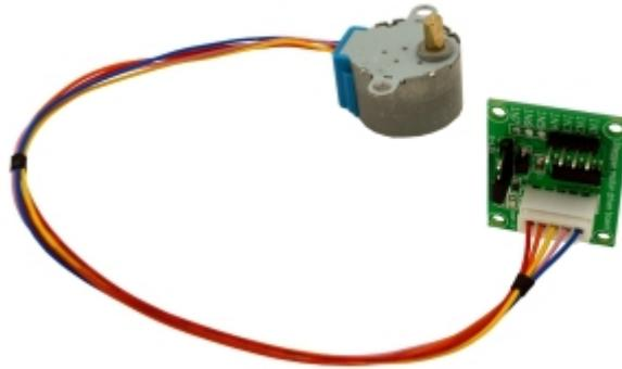
Figura: motor de passo 28BY-J48 (esquerda) e driver ULN2003 (direita)
